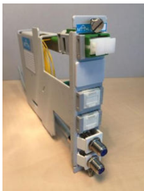
Zdjęcie 2. Widok modułu abonenckiego budynkowego (MAB).
